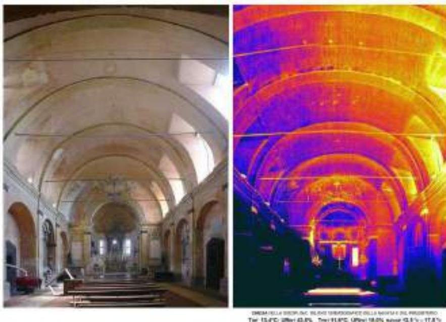
Questa foto composta ( Tradizionale/Termografica ) rappresenta la navata ed il presbiterio di una chiesa. L'indagine è stata eseguita per analizzare il loro degrado causato dall'umidità di infiltrazione e rilevare eventuali distacchi di porzioni di intonaco. Le porzioni blu della navata e del presbiterio, nella porzione Termica, sono le parti interessate dalle infiltrazioni meteoriche e quindi anche da eventuali distacchi di porzioni di intonaco.
