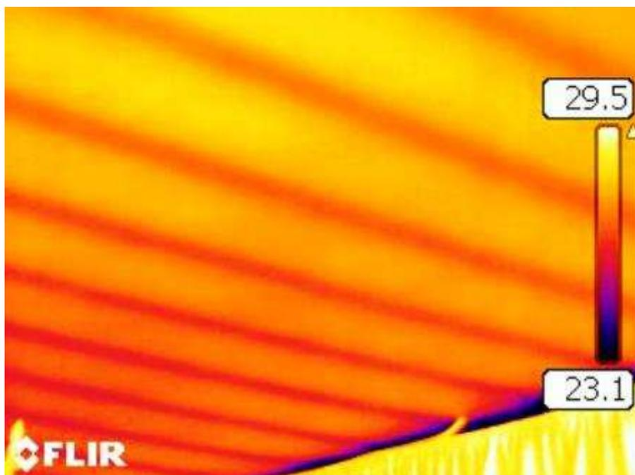
Questo Termogramma ritrae un solaio in latero-cemento e con questa indagine si rileva la sua tessitura. Le bande più scure rappresentano i travetti in c.a. ( nonchè i ponti termici ). Questa indagine è utile in caso di eventuale ristrutturazione e/o per operare tagli dello stesso solaio.
