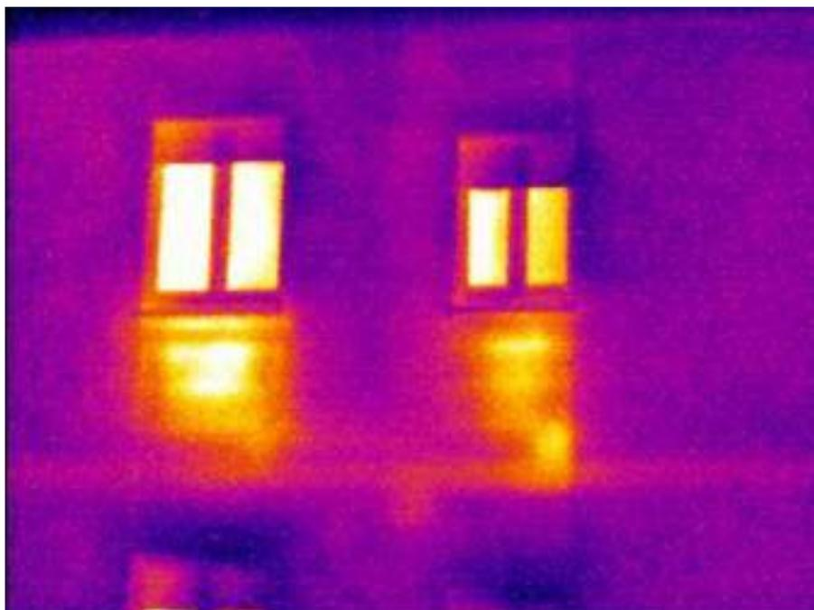
Questa foto Termografica, scattata di notte, ritrae la facciata di un fabbricato. Le due macchie arancioni rappresentano la parte di calore emesso dalle piastre dell'impianto di riscaldamento poste sotto le due finestre che si sta disperdendo all'esterno. Visto che parte del calore emesso dalle due piastre dell'impianto di riscaldamento si sta trasmettendo all'esterno, con questa indagine Termografica si è accertato che la coibentazione termica della parete esterna del fabbricato è scadente.
