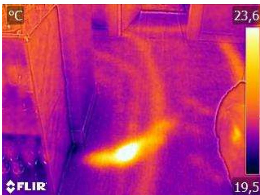
La foto ritrae il pavimento di un comune appartamento dove era presente una perdita nell'impianto termico sottotraccia. Con l'indagine Termografica si è accertato che la perdita era in corrispondenza del corridoio. La macchia arancione del Termogramma rappresenta l'acqua calda che sta fuoriuscendo da un tubo dell'impianto.
